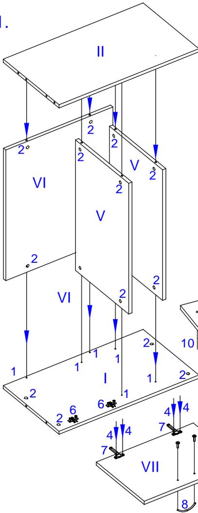
Положить нижнюю полку стороной с четырьмя отверстиями вверх и забить в эти отверстия втулки для крепления опор (11). Вкрутить во втулки опоры (10). Поставить нижнюю полку на опоры.
