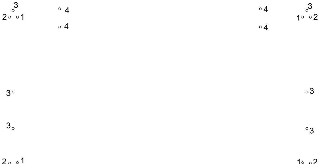
Положить столешницу отверстиями вверх. В зависимости от устанавливаемых опор, забить цанговые футерки (1), из комплекта фурнитуры опор, в соответствующие отверстия:
