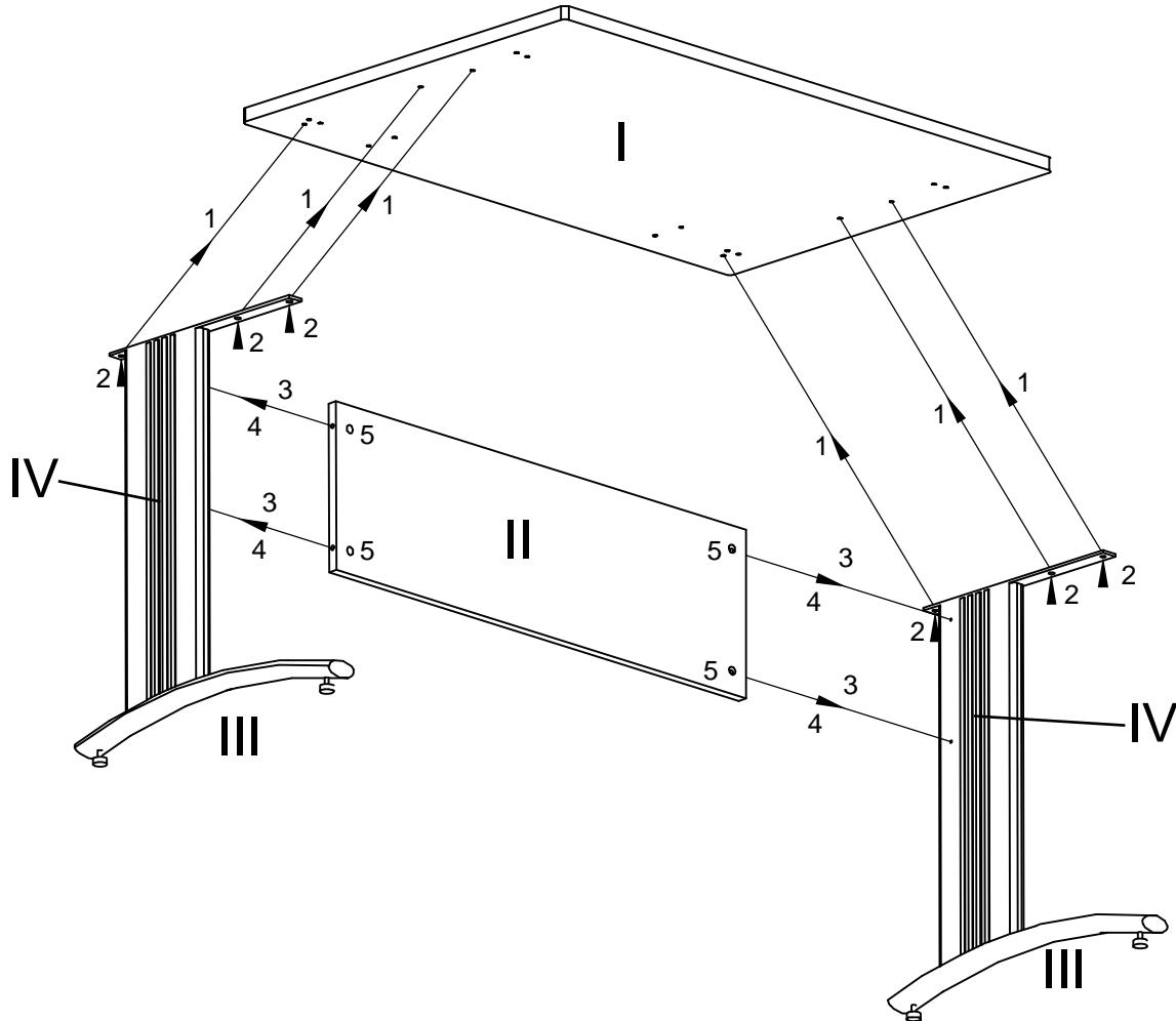
1. При сборке стола в комплекте с передней панелью ФРПД-8/10/12/14/16/9 вкрутить дюбеля стяжек (4) в опоры стола (III) используя шайбы (3).
