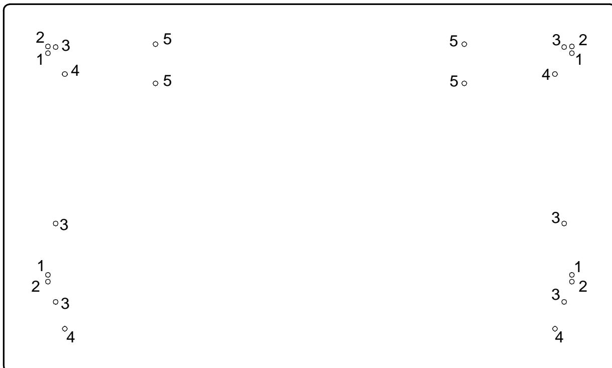
Положить столешницу отверстиями вверх. В зависимости от устанавливаемых опор, забить цанговые футорки (1), из комплекта фурнитуры опор, в соответствующие отверстия:
