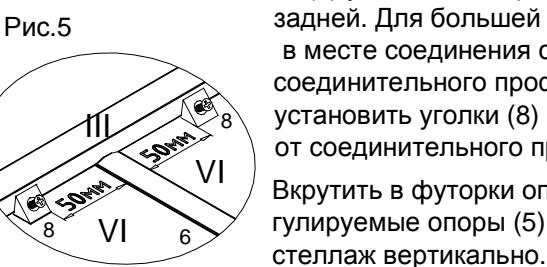
Для фиксации стенки задней (VII) использовать уголки (8) установив их равномерно по периметру стенки задней. Для большей жесткости, рекомендуется в месте соединения стенок задних (VII) и соединительного профиля (6) установить уголки (8) на расстоянии 50мм от соединительного профиля (6) см.рис.5.
