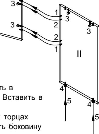
Положить столешницу отверстиями вверх. Забить в столешницу шканты (1) и вкрутить дюбеля стяжек-эксцентриков (2) согласно приложенной схеме расположения отверстий. Надеть столешницу на каркас и затянуть отверткой стяжки-эксцентрики (3) на боковинах. Установить стол. Закрыть торцы стяжек-эксцентриков декоративными заглушками.
