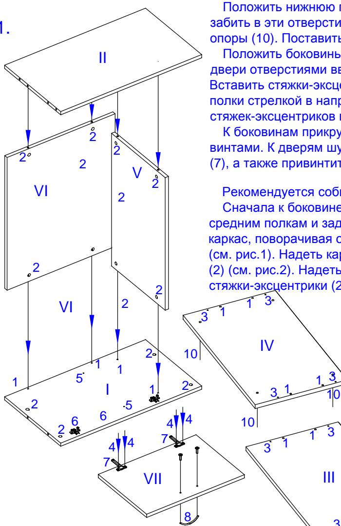
Положить нижнюю полку стороной с четырьмя отверстиями вверх и забить в эти отверстия втулки для крепления опор (11). Вкрутить во втулки опоры (10). Поставить нижнюю полку на опоры.
